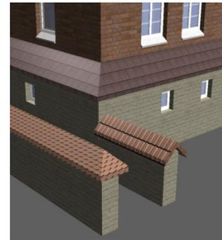
Durch die Editierfunktion kann die Form der Abdeckung nachträglich geändert werden und die Dachfläche zusätzlich mit einer Sparrenschiene versehen werden. Über den Holzbaubefehl können dann auch Sparren verlegt und ausgewertet werden.
